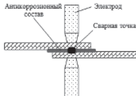
Рис. 2. Схема проведения точечной сварки при соединении внахлест
