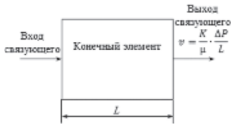
Рис. 2. Закон Дарси применительно к методу конечных элементов ( v – скорость пропитки; K – проницаемость армирующего наполнителя; \mu – вязкость связующего; \Delta P – перепад давления; L – длина конечного элемента)
