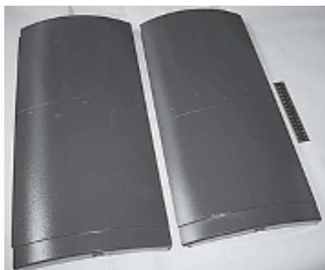
Рис. 4. Бериллиевые детали с нанесенным комплексным покрытием ВЭС-5П (пассивная пленка в сочетании с силикатной эмалью)
