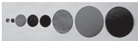
Рис. 3. Рентгеновские вакуум-плотные фольги разного диаметра с защитным покрытием и без него
