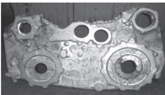
Корпус агрегата (заливка в ПГС, масса 59 кг)
