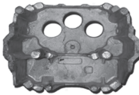
Кронштейн (заливка в ПГС, масса 4,8 кг)
