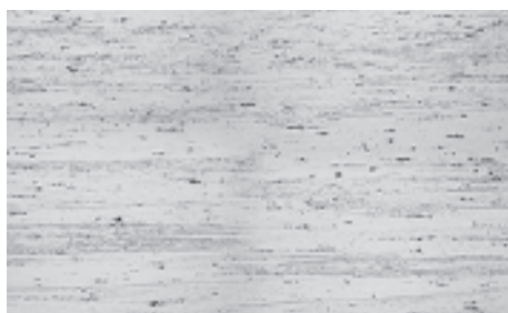
Рис. 8. Микроструктура ( \times 200 ) плиты из сплава В-1469
