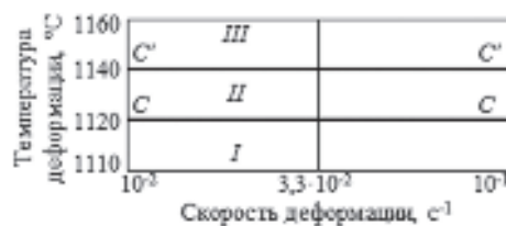
Рис. 6. Диаграмма структурного состояния сплава ВЖ175-ИД, построенная на основании результатов рентгеноструктурных исследований:
