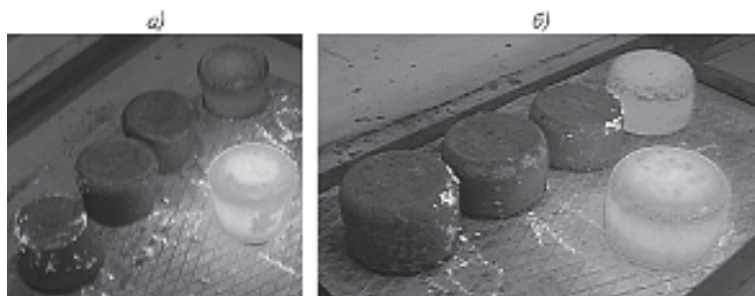
Рис. 10. Внешний вид заготовок на разных стадиях ковочного передела: а – после вытяжки; б – после осадки
