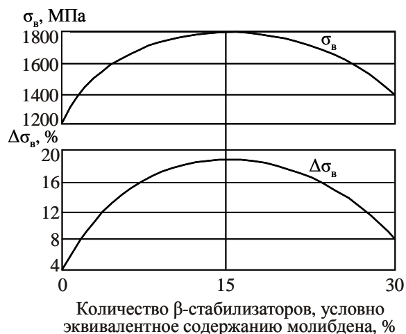
Рис. 7. Влияние легирования на предел прочности титановых сплавов после НТМО и эффективность повышения прочности ( \Delta\sigma_{в} ) при НТМО по сравнению с упрочняющей термической обработкой (УТО)
