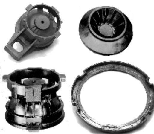
Рис. 3. Литые детали из сплава BT40L
