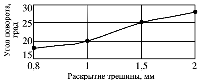
Рис. 3. Зависимость выявляемости трещины от ее ориентации по отношению к пучку излучения
