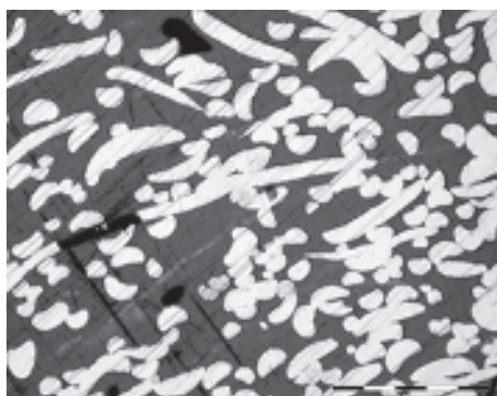
Рис. 1. Микроструктура уплотнительного материала из дискретных металлических волокон
