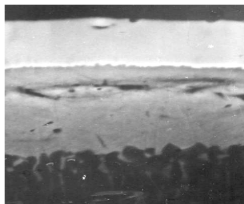
Рис. 7. Микроструктура ( \times 3000 ) сплава ВТ8М-1 с многослойным эрозионно-жаростойким покрытием Zr^+ + ZrN
